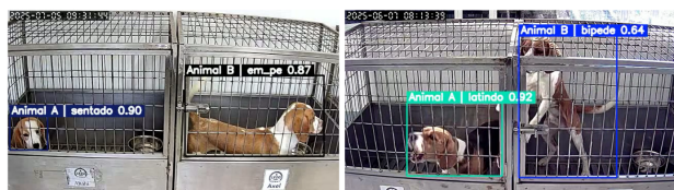
Figura 1. Exemplo de saída do sistema de detecção comportamental, demonstrando a identificação dos animais (A e B), aplicação de bounding boxes e classificação automática dos comportamentos (sentado, em pé, latindo e bipede), acompanhada do nível de confiança do modelo.
